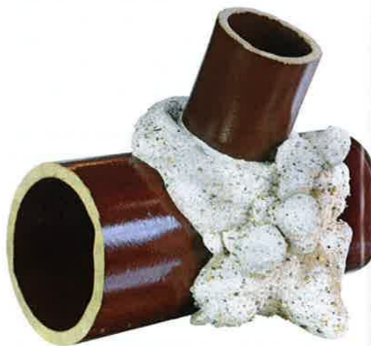
Abbildung 12: ausgegrabener Stutzen nach der Injektion [3]
